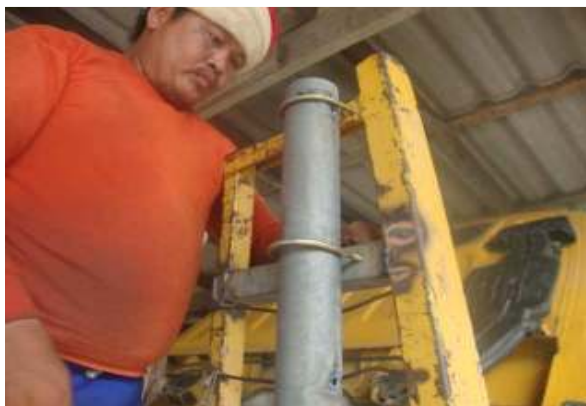
รูปที่ 9 ท่อเหล็ก \varnothing 3 นิ้ว x 3.6 มม. มาติดตั้งกับกระบะรถ
