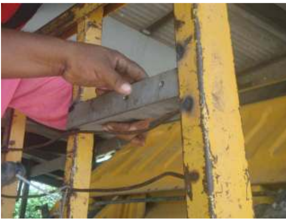
รูปที่ 7,8 นำเหล็กฉากมาติดตั้งกับกระบะรถ
