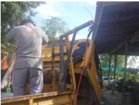
รูปที่ 12,13 นำท่อเหล็ก \varnothing 2 นิ้ว x 3.6 มม. มาเชื่อมติดกับปลอกและคานยื่น
