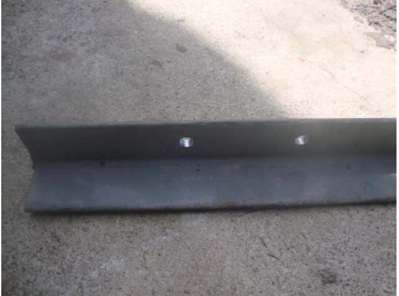
รูปที่ 6 เหล็กฉากขนาด 2 นิ้ว x 2 นิ้ว ยาว 0.35 เมตร
